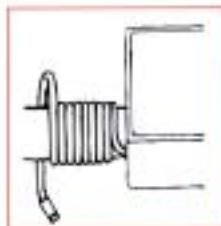
Die Induktionskabel um das Rohr wickeln.
