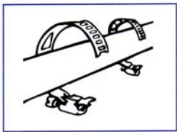
Das Gerät mit den Rohrschellen befestigen.
